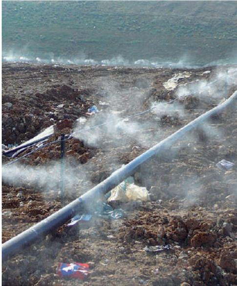
La brumisation haute pression **DID Clim** permet l'élimination des molécules malodorantes et des toxines grâce à l'ajout dans l'eau de brumisation d'un produit actif aux propriétés physico-chimiques destructrices d'odeurs.
