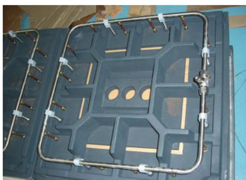
Positionnement des fluotaraudages possible à la demande (distance et orientation sur le tube).
