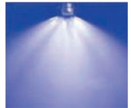
Grâce à plusieurs buses individuelles concentrées sur une même tête, les buses de pulvérisation à jets multiples permettent d'obtenir une augmentation considérable de la surface de contact. Les cônes creux pulvérisent les uns dans les autres et produisent une pulvérisation fine à cône plein, offrant ainsi une couche d'eau dense et turbulente.
